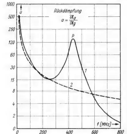
Bild 7. Rückdämpfung  $a = U_a/U_g$ ; Kurve 1: Abschwächung des Signales von der Anode zum Gitter der Röhre PC 900. Kurve 2: Zusammenhang zwischen Rückdämpfung und Frequenz für  $C_{ag} = 0,35$  pF. P = Parallelresonanzpunkt
