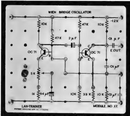
Lehrtafel „Lan-Trainer“ mit sichtbarer Schaltung und austauschbaren Bauelementen. Über die Schraubenköpfe sind die Bauelemente zugänglich
