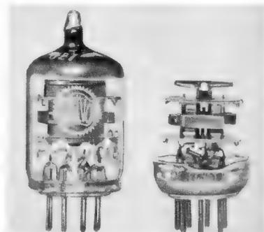
Kolben und System der Triode PC 900 in natürlicher Größe
