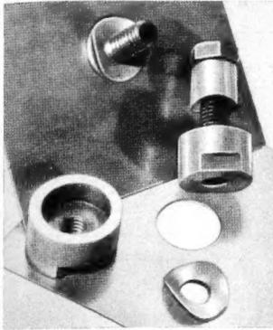
In 1½ Min. werden mit dem **Rekordlocher** einwandfreie Löcher in Metall und alle Materialien gestanzt. Leichte Handhabung – nur mit gewöhnlichem Schraubenschlüssel. Standardgrößen von 10-61 mm Ø, ab 9.10 DM
