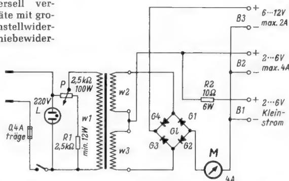
Bild 2. Einfache Schaltung für ein Ladegerät. Die Bereiche werden über die verschiedenen Anschlußbuchsenpaare gewählt
