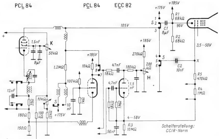
Der Kondensator wurde durch einen spannungsfesten Typ ersetzt, und das Fernsehgerät arbeitete wieder normal. Der fehlerhafte Kondensator zeigte einen Gleichstromwiderstand von rund 200 MΩ, der sich durch Erwärmung wesentlich verkleinerte. Im Empfänger war dieser Kondensator in der Nähe von sich stark erwärmenden Röhren über dem Chassis montiert, was die Erscheinung des langsam immer heller werdenden Bildes erklärte.
