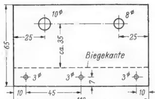
Bild 11. Abmessungen des Befestigungswinkels für den Bereichsum-schalter und den Selengleichrichter
