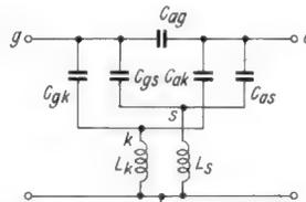
Bild 6. Darstellung der drei Verkopplungspfade als überbrücktes Doppel-T-Glied
