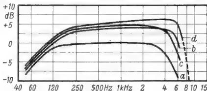
Bild 7. Frequenzgänge von Randspuren aus Agfa-Magnetonbändern, gemessen mit einem Nf-Strom von 0,01 mA und einem Hf-Strom von 0,5 mA
