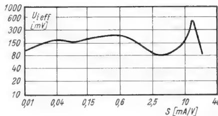
Bild 5. Kreuzmodulation ( $U_{i\text{eff}} = f(S)$  für  $m_k = 1\%$ ) bei  $-U_b = 200$  V und  $R_k = 4,3$  kΩ
