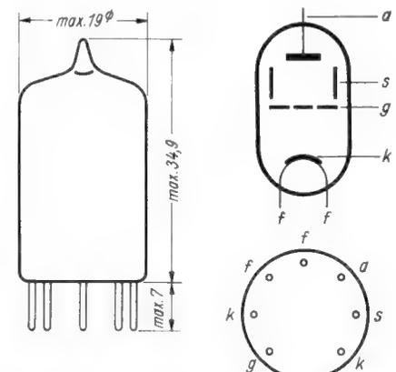
Bild 2. Sockelschaltung und Abmessungen der Röhre PC 900 im Maßstab 1 : 1
