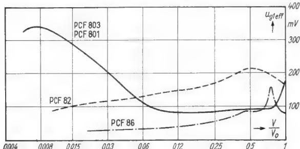
Bild 2. Für 1% Kreuzmodulation zulässige Stör-Wechselspannung am Gitter in Abhängigkeit vom Regelverhältnis  $V/V_0$  ( $V_0$  = volle Verstärkung,  $V$  = herabgeregelte Verstärkungswert) für die Röhren PCF 801/PCF 803 sowie PCF 82 und PCF 86
