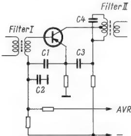
Infolge der fehlerhaften ersten Zf-Stufe begann das Transistorgerät zu „tuckern“. Der Kondensator C 4 hatte seine Kapazität verloren, die Stufe war verstimmt
