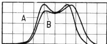
Bild 6. Durchlaßkurven bei voller Ankopplung der Röhre PCF 803 an den Eingangskreis, jedoch mit einem Kompensationswiderstand von  $20 \Omega$  in der Katodenzuleitung des Pentodenteils; A = volle Verstärkung, B = Verstärkung im Verhältnis 1 : 20 heruntergeregelt
