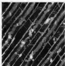
Mikroaufnahme einer unter durchschnittlichen Wohnbedingungen aufbewahrten Schallplatte: Der angesammelte Staub ist deutlich sichtbar.
