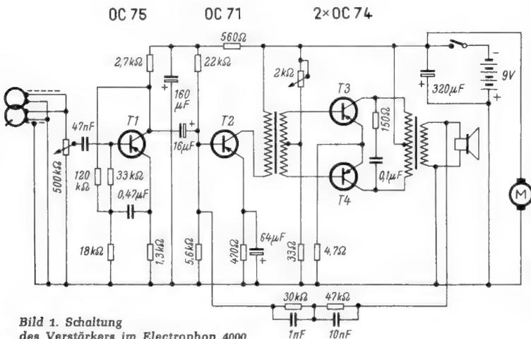
Bild 1. Schaltung des Verstärkers im Electrophon 4000
