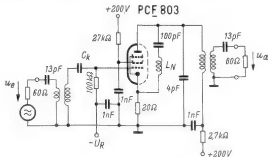
b) Kompensation der Änderungen der Röhren-Eingangskapazität bei sich ändernder Steuergitter-Gleichspannung durch einen nicht kapazitiv überbrückten Katodenwiderstand.
