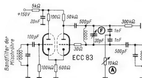
Bild 3. Filter zum Ausblenden von Störfrequenzen im Zf-Kanal (T-notch-Filter)
