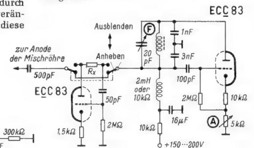
Bild 2. Q-Multiplier zum wahlweisen Anheben oder Ausblenden bestimmter Frequenzen
