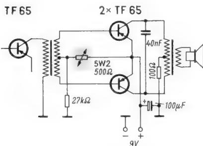
Der gekennzeichnete Heißeleiter berührte den metallenen Lautsprecherkorb und führte dadurch zu starken Verzerrungen der Endstufe
