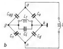
Bild 8b. Vereinfachte Brückenschaltung entsprechend Bild 8a
