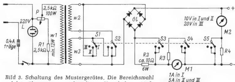
Bild 3. Schaltung des Mustergerätes. Die Bereichsmahl erfolgt über einen mehrpoligen Umschalter. Meßinstrumente für Ladestrom und Batteriespannung sind vorgesehen
