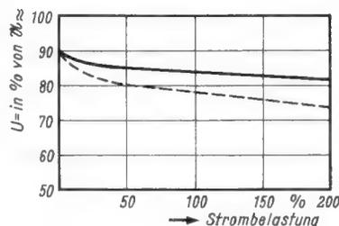
Bild 5. Abgegebene Gleichspannung eines Graetz-Gleichrichters in Prozent der Anschlußspannung bei verschiedener Strombelastung. Kurve a für Nennanschlusspannung, Kurve b für halbe Nennanschlusspannung (nach AEG-Unterlagen)
