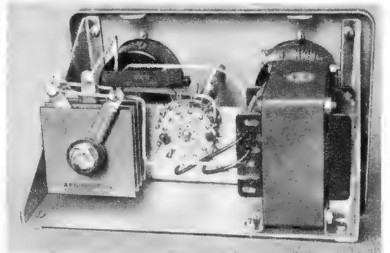
In Bild 12 ist der Aufbau des Gerätes von hinten zu sehen. Der 10-Ω-Widerstand R 2 ist freitragend zwischen dem Minusanschluß des Selengleichrichters und dem Umschalter angeordnet. Der 2,5-kΩ-Widerstand der Primärseite des Transformators ist mit einem Pol unmittelbar mit der einen Klemme des Ladestromeinstellers P verbunden, sein anderer Anschluß wird von einem auf dem Chassis montierten keramischen Stützpunkt getragen (vgl. Bild 8).
